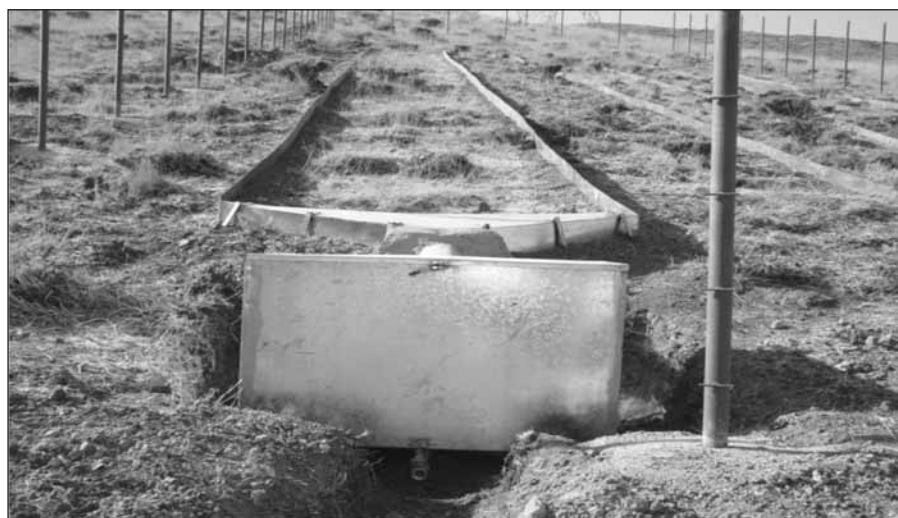
شکل ۱- نمایی از پلات فرسایشی و مخزن جمع‌آوری رواناب در حوضه نمونه
