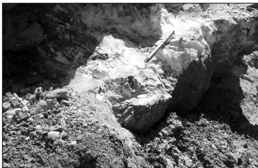
تصویر شماره ۲ - نمونه‌ای از سنگ معدن دونا، حاوی گالن و باریت
