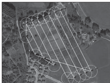
شکل ۵- پرواز یک دران Drone ونحوه عکسبرداری از منطقه کشاورزی
