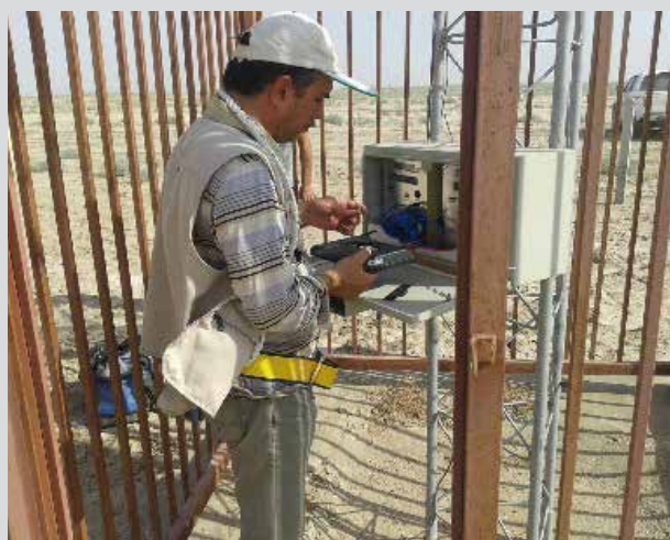
شکل ۱۱: تنظیم و کالیبراسیون دستگاههای ایستگاه سنجش فرسایش بادی و گردوغبار دریاچه ارومیه
