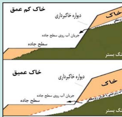
شکل ۱- وضعیت جریان آب‌های زیرسطحی روی ترانشه خاکبرداری و سطح جاده (عابدی و همکاران، ۱۳۹۰)
