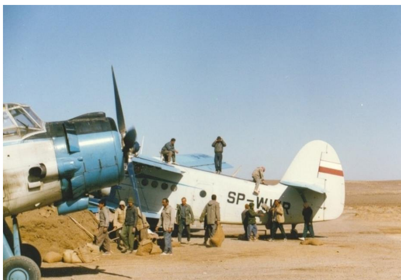
شکل ۲-۶- بذرپاشی با هواپیما جهت تثبیت ماسه و بیابانزدایی
